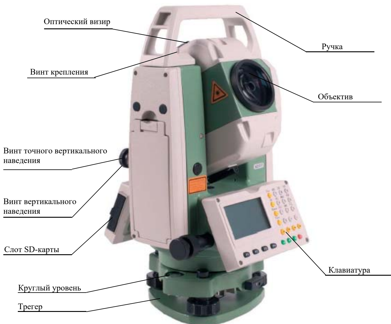
Рисунок 3 - Основные элементы тахеометра RTS102
